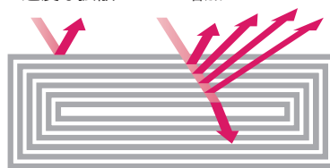
ハイカバー光パウダー (板状の多層構造)
